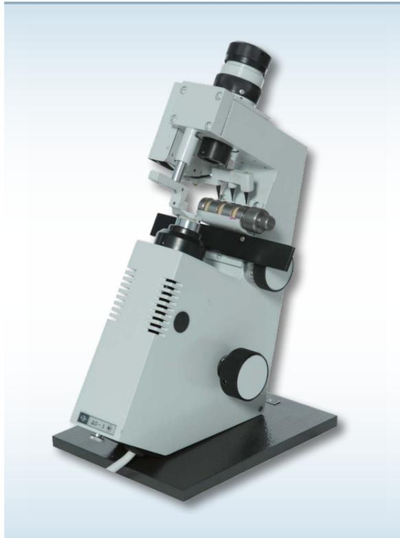
Предназначен для измерения задней вершинной рефракции и призматического действия очковых линз диаметром от 34 до 75 мм, для нанесения положения оптического центра, положения главных сечений у астигматических линз и направления главных сечений у призматических очковых линз. Применяется в поликлиниках при подборе очков и в местах отпуска очков населению.
