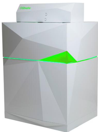
Лазерный измерительно-информационный комплекс МИМ-340 – это уникальный микроскоп с применением технологии модуляционной интерференционной микроскопии (МИМ) (разрешение – до 0,1 нм по вертикали (ось Z) и до 10 нм в плоскости XY).
